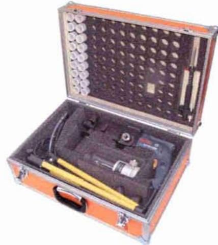
Das Bohrmehlentnahmegerät BMEG dient zur fachgerechten Bohrmehlentnahme, um so den Chloridgehalt von Bauteilen bestimmen zu können.
