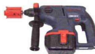
Akku-Bohrhammer mit speziellen Bohrkronen (auch mit Spülkopf zum Nassbohren) passend zum Prüfdurchmesser
