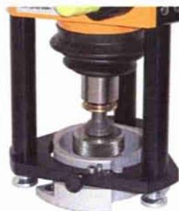
Wand- und Deckenbefestigung mit herausnehmbarem Bohrring für Bohrkronen
