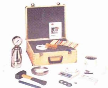
Das CM-Koffergerät liefern wir in einer Holzkofferausführung einschließlich Digitalwaage und Prüfmittel zur Überprüfung von Manometer und Dichtung und in einer preiswerteren Grundausrüstung im Blechkoffer.
