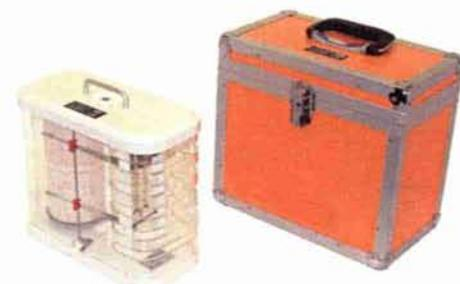
Für die Bauüberwachung liefern wir die Thermo-Hygrographen standardmäßig mit einem Temperaturmessbereich von  $-20^{\circ}\text{C}$  bis  $+60^{\circ}\text{C}$  mit mechanischem Umschaltuhrwerk (1/7 Tage pro Umlauf) oder mit elektronischem Uhrwerk (1/7/31 Tage pro Umlauf). Andere Messbereiche und Aufzeichnungsperioden sind verfügbar.
