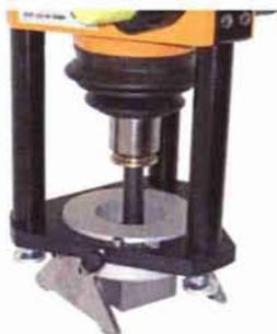
Spezialvorrichtung zur Serienprüfung von Fliesenklebern
